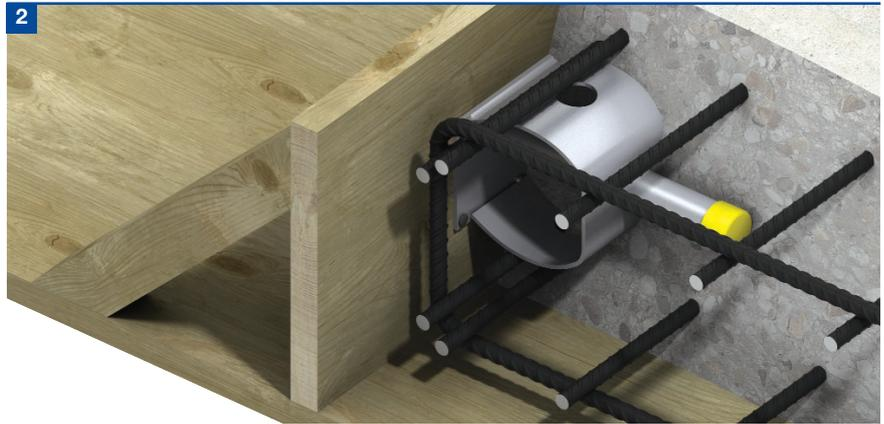
Fije la armadura local en posición alrededor de la vaina junto con otra armadura cualquiera que sea necesaria, asegurando que se mantiene el recubrimiento correcto de la armadura. Vierta el hormigón para completar la instalación de la vaina.
