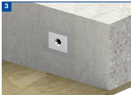
Cuando el hormigón haya alcanzado suficiente resistencia, golpee el elemento de encofrado. Despegue o perforo la etiqueta para dejar al descubierto los agujeros para los pasadores. Cuando se utiliza HLDQ o ESDQ, la etiqueta sólo se debe perforar lo suficiente para permitir la entrada del pasador en la vaina cilíndrica, para evitar la entrada de residuos en la sección rectangular.
