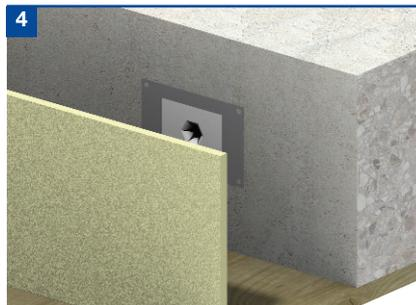
Coloque el relleno de junta comprensible de la anchura adecuada, en el caso de aplicaciones en las que se espera que haya movimiento entre las dos secciones de hormigón.
