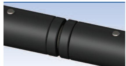
**Nota:** Cuando el acoplador está completamente montado, la parte de rosca visible entre las dos contratuercas no puede ser superior a 20mm.
