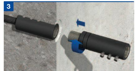
3 Retire el encofrado y desatornille la placa con clavos. Atornille el componente macho hasta el fondo del componente hembra fijo. El componente macho se puede girar una vuelta completa para facilitar la colocación de los pernos en un lugar accesible.
