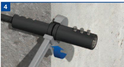
4 Gire la contratuerca por la rosca del componente macho hasta fijar el componente hembra. Apriete con llave la contratuerca hasta el fondo de la sección hembra.
