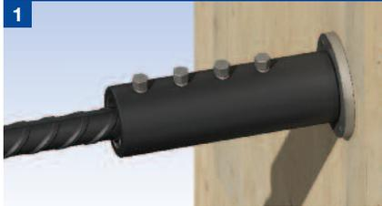
1 Fije la placa con clavos al encofrado y atornille el componente hembra hasta el fondo de la placa. Inserte la barra en el acoplador, asegurándose de que no penetre en la sección roscada. Apriete a mano los pernos rompibles. Compruebe la alineación y haga los ajustes necesarios.
