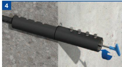
4 Las dos secciones se bloquean unidas al expandir un cono, situado en el centro del acoplador, con la herramienta apropiada.
