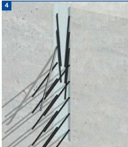
Enderece las barras con la herramienta Ancon Eazistrip adecuado para el tamaño de la barra. Las barras deben enderezarse sólo una vez. Para evitar daño al hormigón contiguo es prudente permitir un periodo de curado de siete días. Véase "Enderezado de las barras" para más información.
