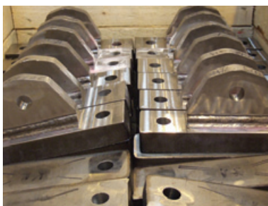
Systèmes de Suspension des Plafond de Tunnels
