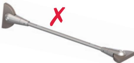
La desalineación máxima de un sistema Ancon es de  $0,5^\circ$ , como se muestra en la ilustración.
