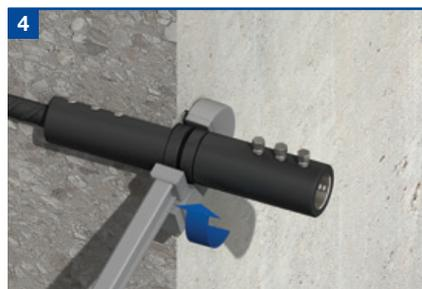
Reculer le premier contre-écrou le long du filetage de la partie mâle jusqu'au contact avec la partie femelle. Serrer et bloquer à l'aide d'une clé.
