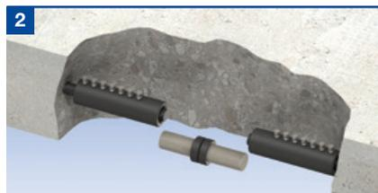
2 Insérer un goujon fileté de la taille adéquate dans l'espace entre les deux armatures, et tourner chaque moitié de manchon de telle façon que le goujon soit entièrement engagé dans chaque extrémité taraudée.
