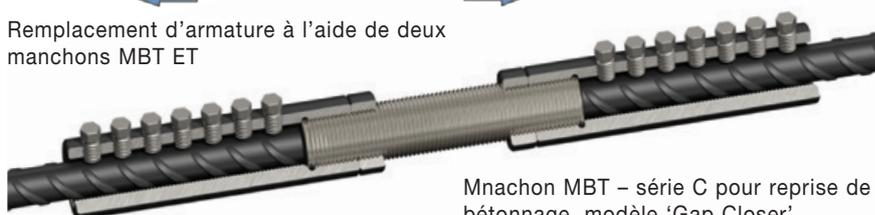
Manchon MBT – série C pour reprise de bétonnage, modèle 'Gap Closer'. Goujon central fileté modifié afin de correspondre à l'espace à remplir.
