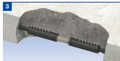
3 Serrer les contre-écrous contre les manchons. Serrer les têtes des vis jusqu'au cisaillement pour compléter la mise en œuvre en commençant au milieu et en travaillant vers les extrémités, serrer partiellement les vis fusibles à l'aide d'une clé à cliquet ou d'une visseuse. Ne pas utiliser de clé à chocs. Répéter l'opération, cette fois-ci en serrant à fond jusqu'au cisaillement des têtes de vis.
