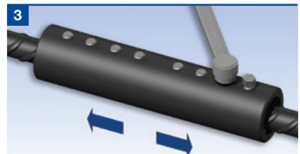
Sur l'une des deux moitiés du manchon, en commençant au centre et en travaillant vers l'extrémité, serrer partiellement les vis fusibles à l'aide d'une clé à cliquet ou d'une visseuse. Ne pas utiliser de clé à chocs. Répéter l'opération, cette fois-ci en serrant à fond jusqu'au cisaillement des têtes de vis. Répéter ensuite les mêmes opérations sur la deuxième moitié du manchon.
