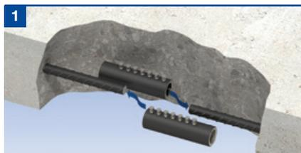
1 Orienter de telle façon que les portions taraudées se font face et enfilez les deux moitiés du manchon de reprise de bétonnage sur les extrémités opposées des armatures ancrées, laissant l'espace entre elles visible.
